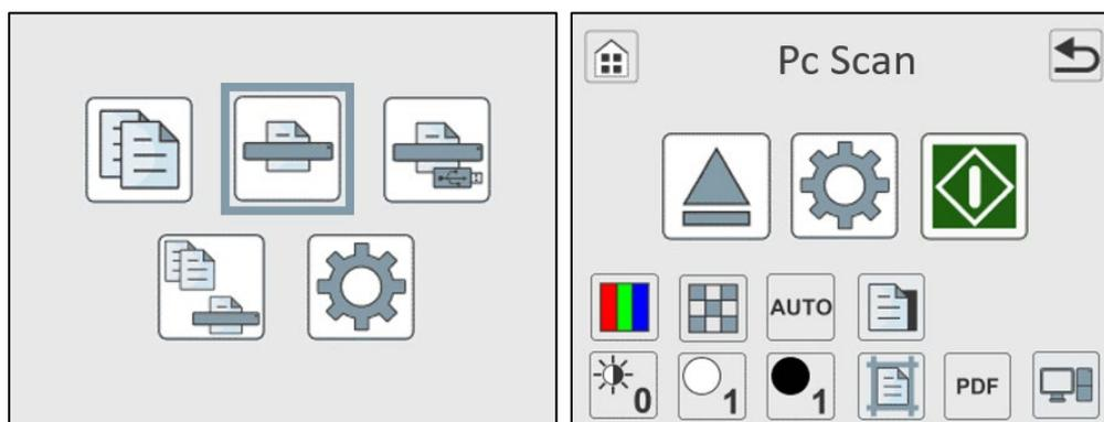
Der PC, der für „Scan-to-PC“ benutzt wird, wird auf dem Bildschirm „Scan-to-PC“ angezeigt. Dieses Beispiel zeigt den momentan ausgewählten PC als PCX. Das bedeutet, dass der Scanner eine automatische PC-Suche durchführt und den Benutzer auffordert, vor dem Ende jedes Scans einen PC zu wählen.
