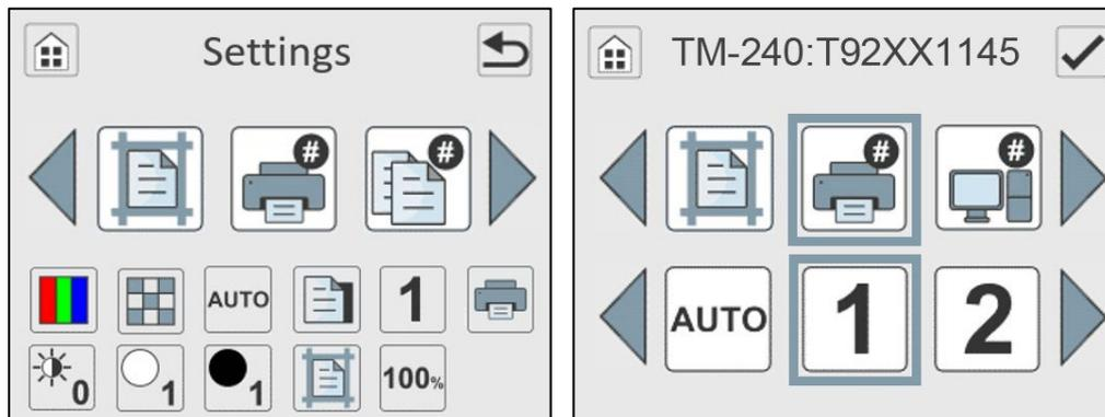
Hinweis: Die Seriennummer der zugewiesenen PC# wird oben auf dem Bildschirm angezeigt. Wenn die Seriennummer rot angezeigt wird, ist der Drucker nicht verfügbar. Der Verbindungsstatus wird nur aktualisiert, wenn Sie das Menü aufrufen.
