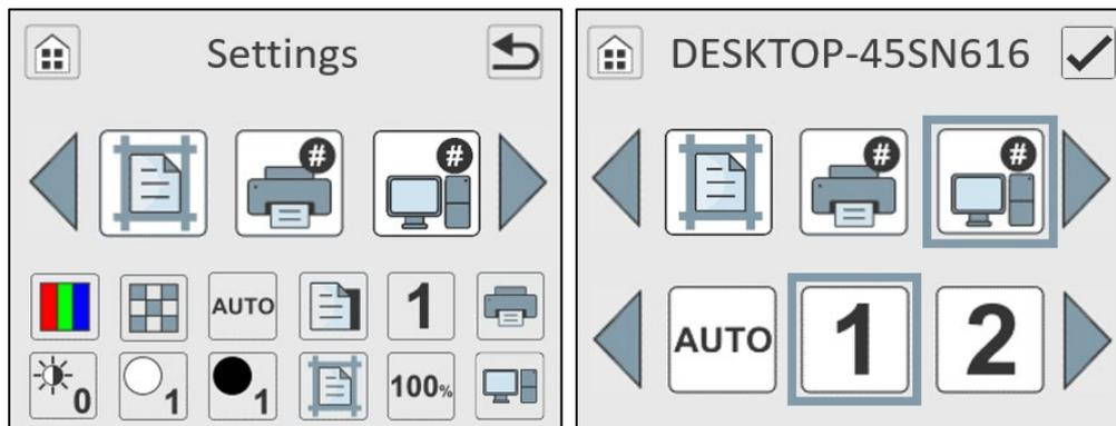
Hinweis: Der Hostname der zugewiesenen PC# wird oben auf dem Bildschirm angezeigt. Wenn der Hostname rot angezeigt wird, dann ist der PC nicht eingeschaltet oder die ScanAppL wird nicht ausgeführt. Der Verbindungsstatus wird nur aktualisiert, wenn Sie das Menü aufrufen.
