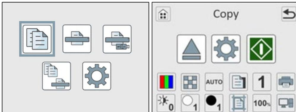
Der Drucker, der für das Kopieren benutzt wird, wird auf dem Bildschirm „Kopieren“ angezeigt. Dieses Foto zeigt den momentan ausgewählten Drucker als DruckerX, was bedeutet, dass der Scanner eine automatische Druckersuche durchführt und den Benutzer auffordert, vor Ende eines jeden Scans einen Drucker zu wählen.
