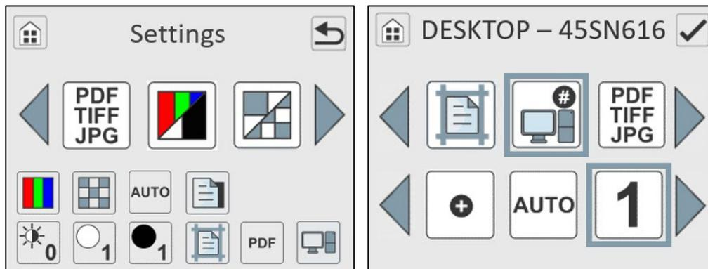
Hinweis: Der Hostname der zugewiesenen PC# wird oben auf dem Bildschirm angezeigt. Wenn der Hostname rot angezeigt wird, ist der PC nicht eingeschaltet oder die ScanAppL wird nicht ausgeführt. Der Verbindungsstatus wird nur aktualisiert, wenn Sie das Menü aufrufen.
