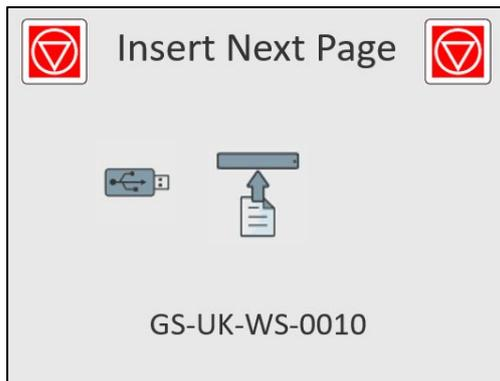
Nachdem alle Seiten hinzugefügt wurden, drücken Sie die rote Stopptaste, um die Datei zu schließen.
