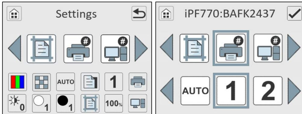
Hinweis: Die Seriennummer der zugewiesenen Drucker# wird am oberen Rand des Bildschirms angezeigt. Wenn die Seriennummer rot angezeigt wird, ist der Drucker nicht verfügbar. Der Verbindungsstatus wird nur aktualisiert, wenn Sie das Menü aufrufen.
