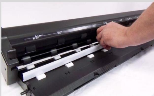
8. Ziehen Sie von der neuen Halteplatte den Schutzstreifen des Befestigungsbands ab.
