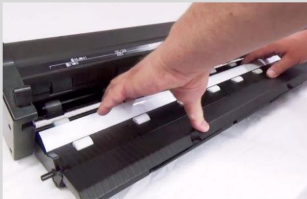
9. Positionieren Sie die Halteplatte so in der Lücke neben den Federhaltern, dass das Befestigungsband nach oben zeigt.
