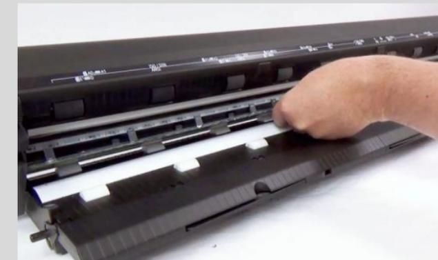
Hinweis: Vom Glas wurde eine Verriegelungslasche entfernt. Die entfernte Lasche muss beim erneuten Anbringen zum unteren Gehäuse des Scanners zeigen.
